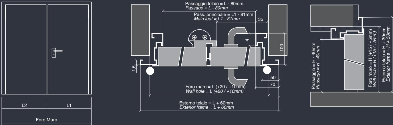
Peso della porta: REI 60 = 37 Kg / mq di foro muro • REI 120 = 42 Kg / mq di foro muro.
