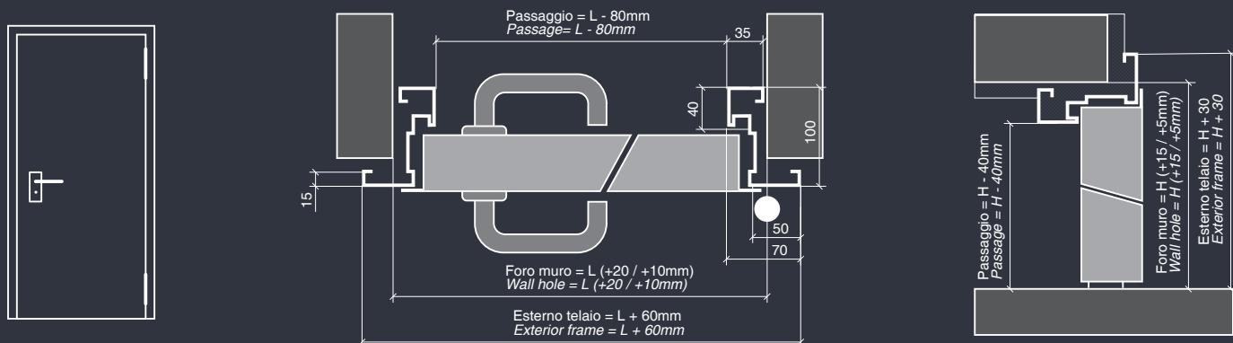
Peso della porta: REI 60 = 37 Kg / mq di foro muro • REI 120 = 42 Kg / mq di foro muro.
